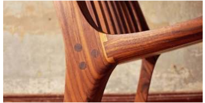
/ Exakte Passungen: Die Sitzfläche des Schaukelstuhls ist in die Beine eingezapft, verleimt und zusätzlich verschraubt – Holzdübel verdecken die Schrauben.
